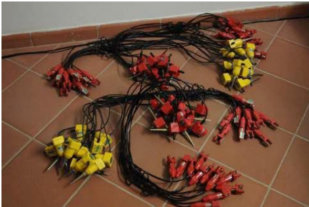
A destra: 32 picchetti in acciaio inox per Tomografie Elettriche (0,50 m); 32 picchetti in acciaio inox per Tomografie Elettriche (1,00m); 2 cavi per Tomografia Elettrica con 32 agganci distanziati 5 m l'uno dall'altro; Energizzatore per Tomografie Elettriche 12 Volts – 500 mA.
