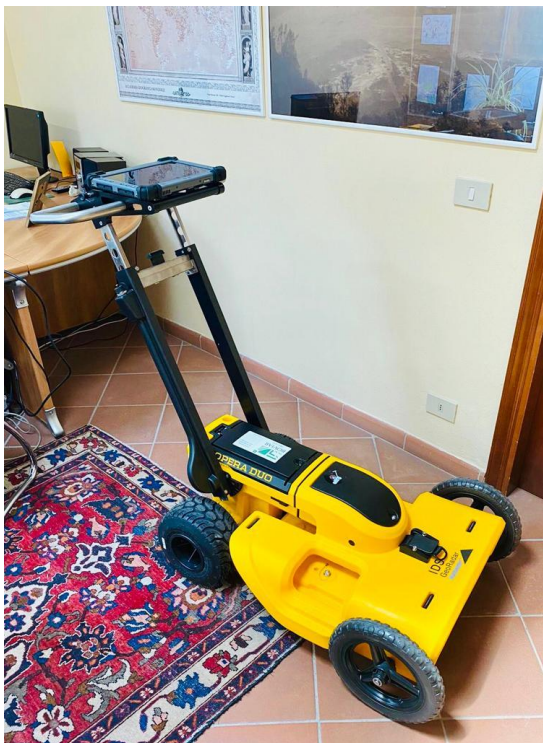
1° Foto: Antenna GeoRadar da 200 e 600 MHz; 2° Foto: PC portatile per acquisizione dati georadar.
