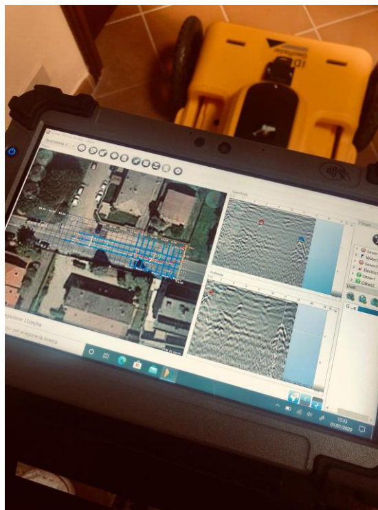
1° Foto: Antenna GeoRadar da 200 e 600 MHz; 2° Foto: PC portatile per acquisizione dati georadar.
