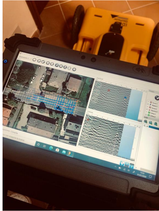
1° Foto: Antenna GeoRadar da 250 e 700 MHz; 2° Foto: PC portatile per acquisizione dati georadar.
