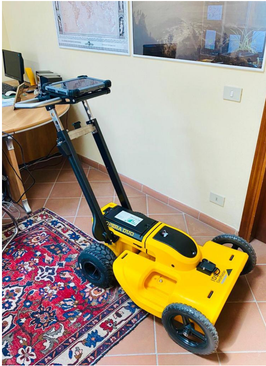
1° Foto: Antenna GeoRadar da 250 e 700 MHz; 2° Foto: PC portatile per acquisizione dati georadar.
